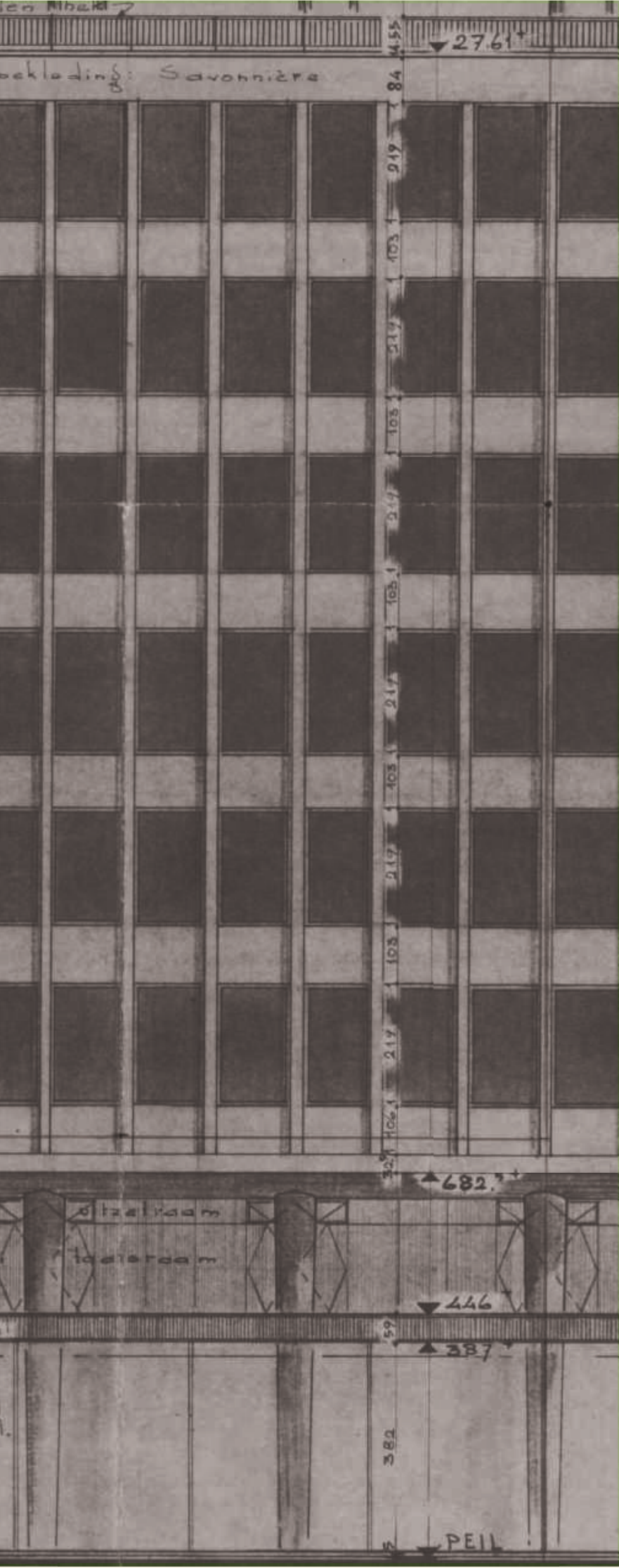
De karakteristieke kolommen (1), natuurstenen gevelelementen (2) en etalage-volumes (3) aan de voorgevels, evenals de eenlaagse dakopbouw (4), zijn als van monumentale waarde beoordeeld in 2022.
